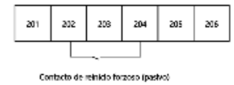
b. Modo de conexión de retardo forzoso (Tipo Normal)
